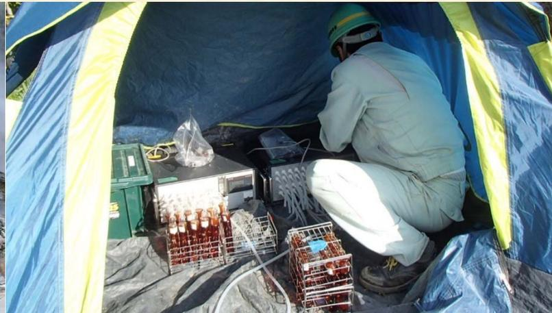
左／硫化水素の測定のために設置したテント。右／測定機材の設置の様子。メチレンブルー吸光光度法により測定。
