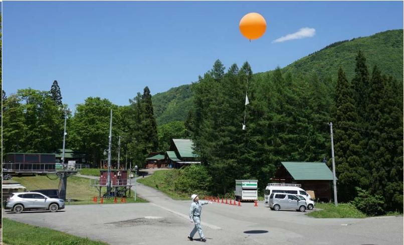
左／地上気象観測のための装置。風向、風速、気温などを観測。右／GPS ソンデを用いた高層気象観測の様子。高度 1,000m までの風向、風速、気温を観測。
